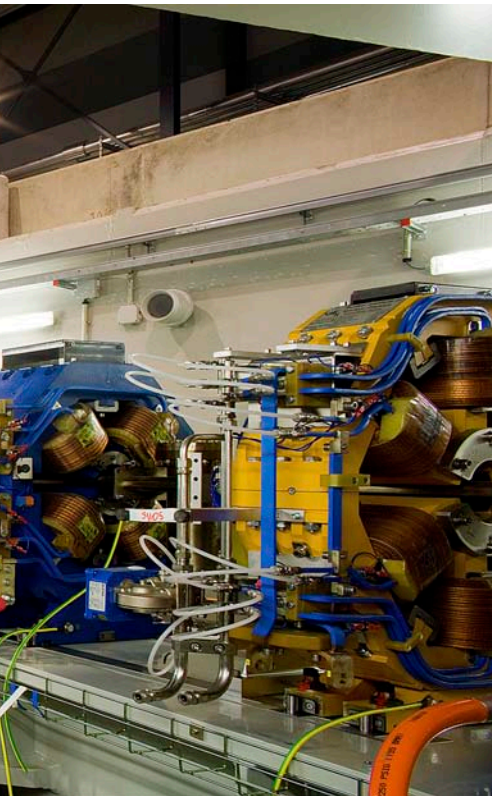
Interior del túnel d'acceleradors, on es veu a la dreta l'anell d'emmagatzematge i a l'esquerra l'anell propulsor. A la fotografia de baix es veu la línia de llum CIRCE, a la qual es fan estudis d'espectroscòpia de fotoemissió.
