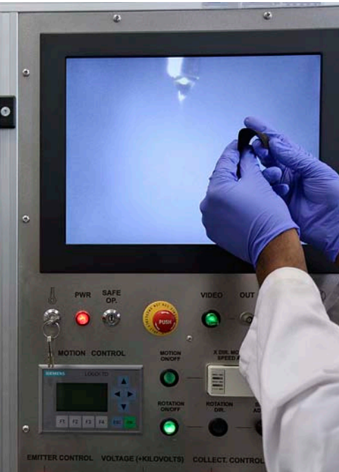
màquina d'electrospinning per teixir nanomaterials pels electrodos de les bateries i supercondensadors.
