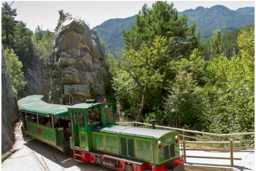
El carrilet circulant amb passatgers. La locomotora, construïda per l'empresa alemanya Schöma, remolca tres cotxes de viatgers que poden arribar a transportar 80 persones gràcies a la seva potència superior.
