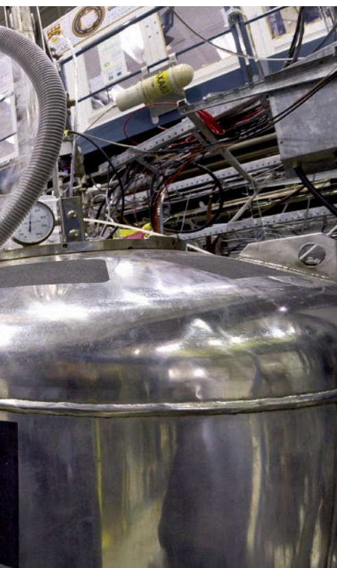
A la imatge de l'esquerra, Andrea Gutiérrez transfereix heli líquid d'un contenidor a dins del criòstat que conté la trampa magnètica del superconductor utilitzat en el projecte ALPHA. Damunt aquestes línies, un àtom d'antihidrogen a la superfície interna de la trampa del projecte ALPHA.
