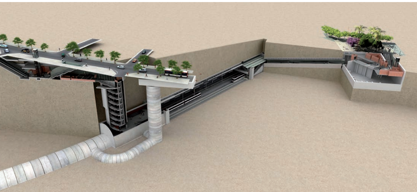
Secció virtual de les obres de noves estacions de metro de la Línia 5. A l'esquerra, la nova estació de la Vall d'Hebron, on s'observa la confluència de les línies 3 i 5 de metro, així com els nous vestíbuls i accessos a l'estació. A la dreta, la nova estació del Carmel, on es pot observar els seus accessos des de l'exterior.
