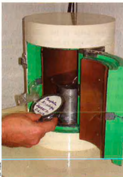
Espectròmetre per analitzar la presència de radacions en les mostres del producte de Flix.
