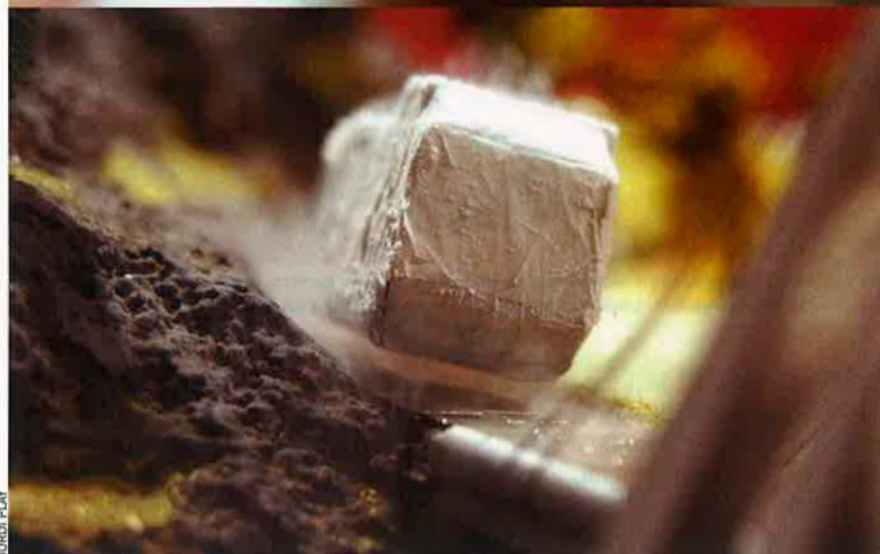
A dalt, una peça banyada en nitrogen, que ha esdevingut superconductora, és aixecada sense contacte. A sota, un prototipus de tren que levita sobre el que faria de via. Gràcies a la combinació de superconducció i camps electromagnètics, funciona amb una lleugera empenta.
