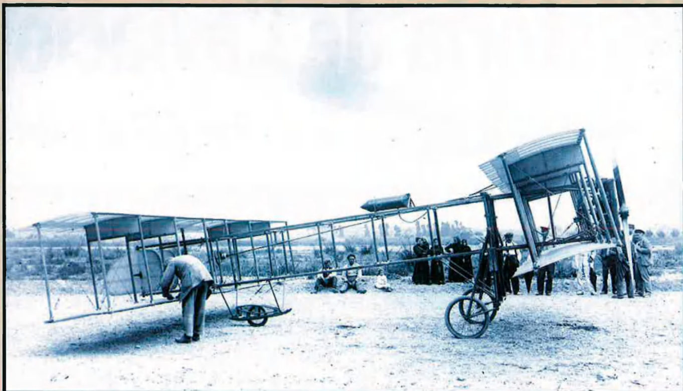
Biplà amb ales en tàndem construït per l'enginyer industrial Gaspar Brunet.
