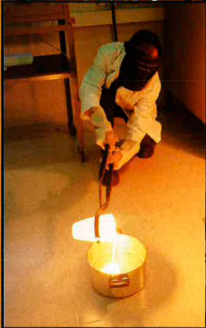
Un dels tècnics de l'ITC, durant el procés de frita, que aconsegueix donar a la ceràmica una aparença vidriada i brillant.
