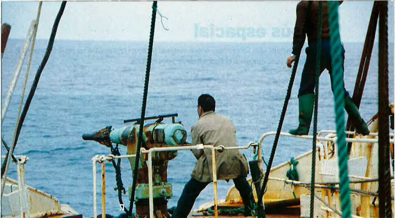
Els arpons són disparats amb l'ajut d'un canó i van provistes d'una càrrega explosiva a la punta.
