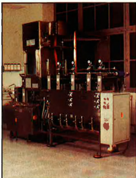
Instal·lació per a verificar la fixació de tints als tèxtils.
